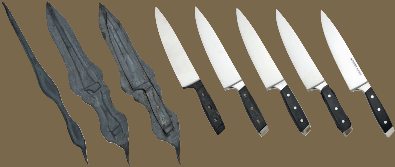
La fabricación de un cuchillo Felix; desde el cuchillo en bruto hasta el producto terminado atraviesa aprox. 45 pasos de trabajo. La mayoría de ellos, a mano.
