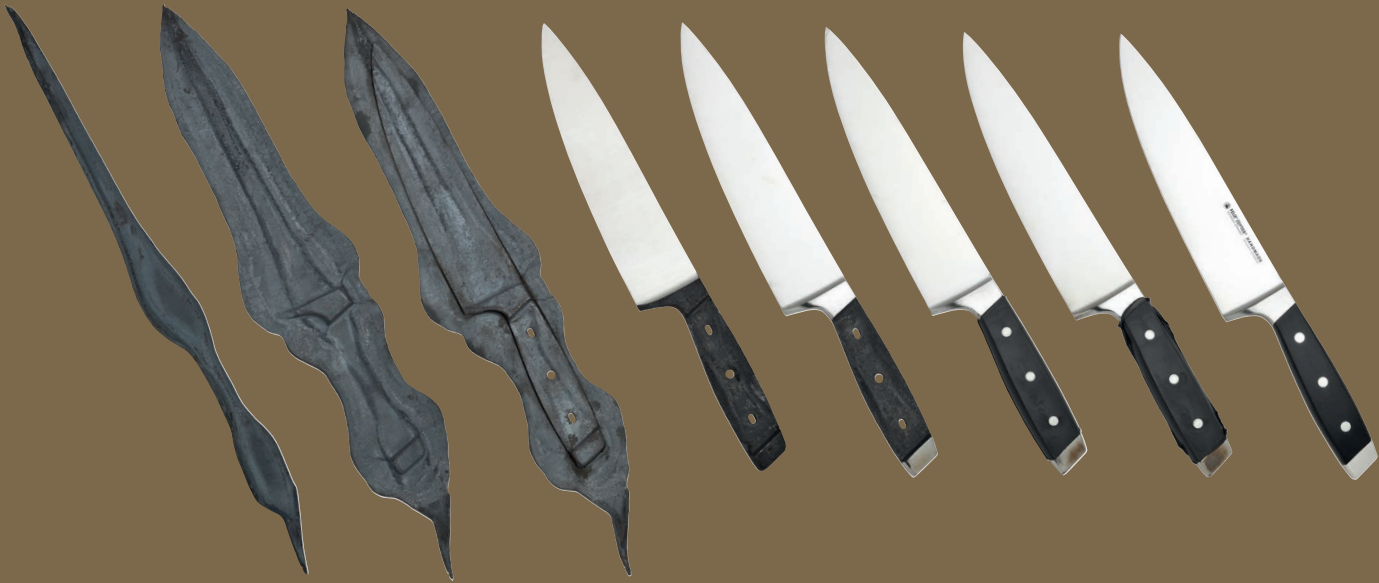
A Felix kések gyártásuk során a nyers késtől a kész termékig kb. munkameneten halad át. A legtöbb feldolgozási munkamenet kézzel történik.
